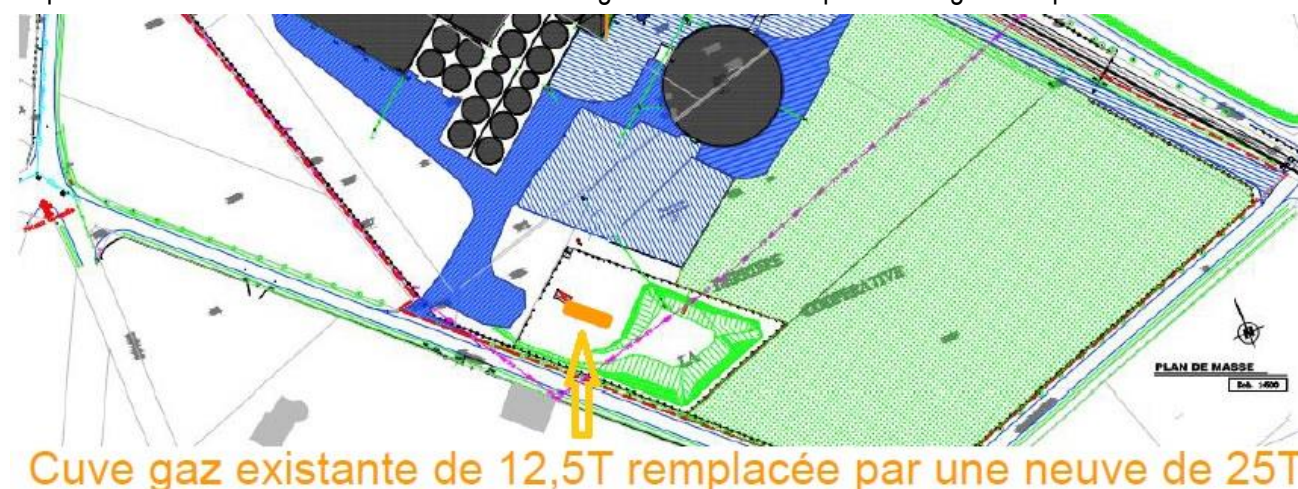
Figure 15 : Positionnement de la nouvelle cuve de GPL de 25 tonnes
